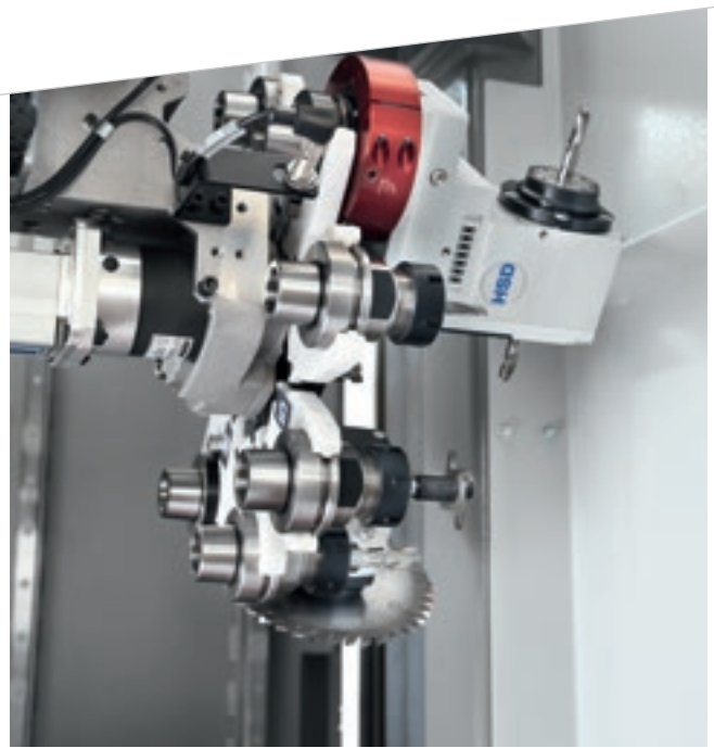
Werkzeugwechsler mit 8 Positionen zum Verwalten verschiedener Aggregate, um die Flexibilität der Maschine zu erhöhen.
