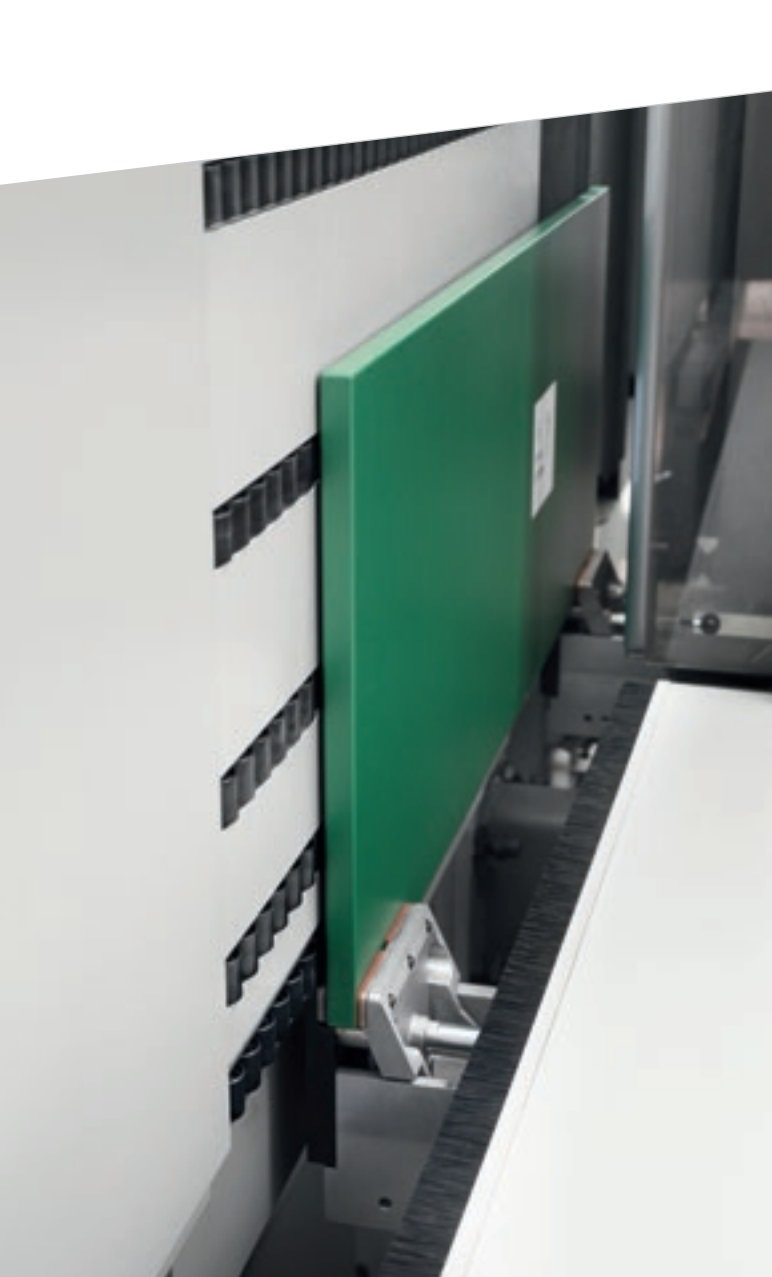
Werkzeugwechsler mit 8 Positionen zum Verwalten verschiedener Aggregate, um die Flexibilität der Maschine zu erhöhen.
